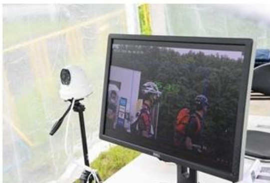
1.検温テントに設置されたA Iサーモカメラとモニター。 カメラ導入により、入場口での混雑を緩和することができました
